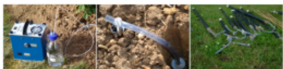
Figure 2. De gauche à droite : matériel de prélèvement de l'eau dans les bougies poreuses, bougie implantée verticalement (10 cm sous la surface du sol), et bougies de 50 cm prêtes à l'implantation.
